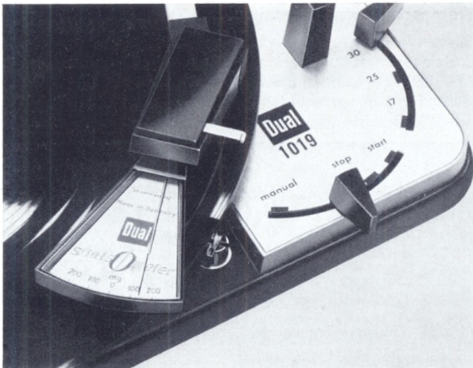
Abb. 53 Tonarm des Dual 1019 mit eingesetztem Skate-o-meter
