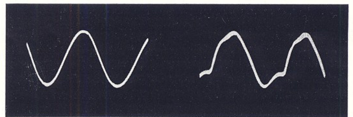
Abb. 42 Kurvenform-Verzerrung durch falsche Auflagekraft
