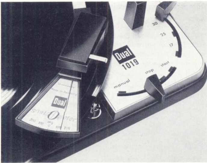
Abb. 53 Tonarm des Dual 1019 mit eingesetztem Skate-o-meter
