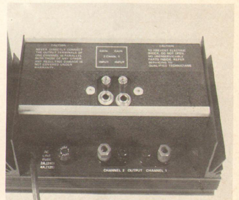
2 Ein- und Ausgänge des Crown D-150
