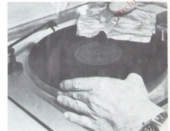
13 In dieser Haltung wird die Schallplatte auf den Plattenteller gelegt. Auf diese Weise kommt die Plattenoberfläche nicht mit Hautteilen der Hände in Berührung, so daß sonst unvermeidliche Fettabdrücke unterbleiben
