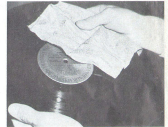
12 Dann wird die Schallplatte gegen die linke Hand gedrückt und mit umgeschlagenem Plattentuch durch stufenweise Drehbewegungen von Staub befreit. Gleichzeitig erfolgt ein Ladungsausgleich zwischen den beiden Plattenseiten
