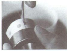
Hier werden Tieftonmembranen und Gummisicken verbunden.
