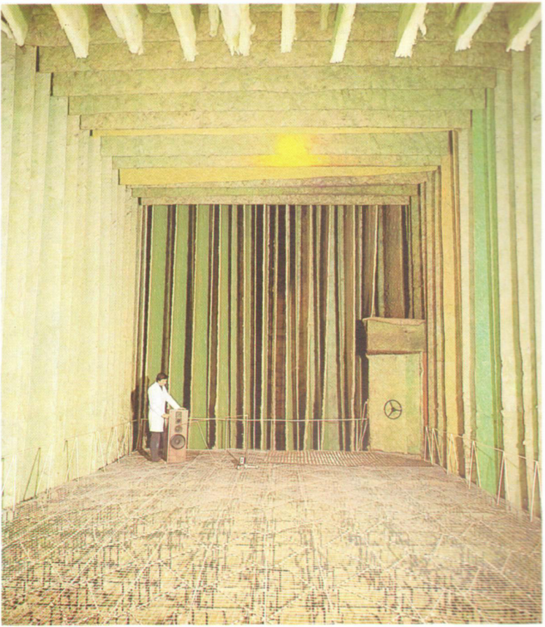
Der schalltote Raum von Cabasse mit 2.000 m 3 Volumen.
