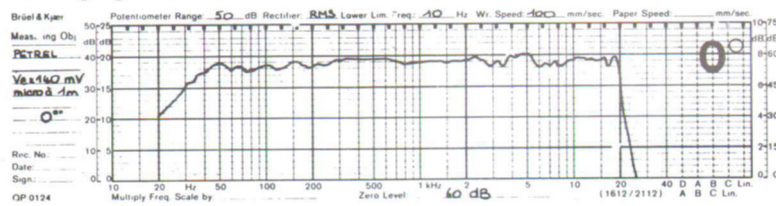
Übertragungskurven der Petrel M 2 bei 0° - 30° - 45° Einfallswinkel
