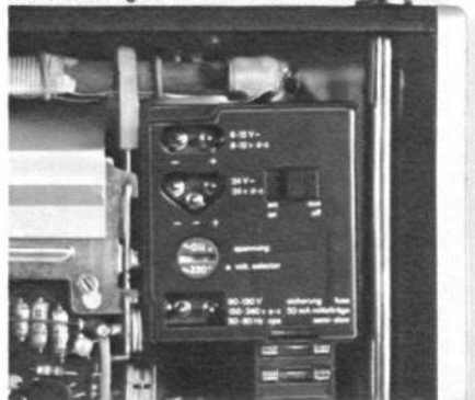
einbaufähiges Netzteil TN 1000
