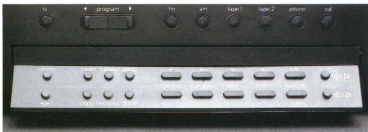
Nebenfunktionen versteckt: Dieses Bedienpult ist versenkbar
