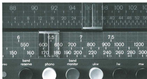
Millimeterraster-Skala und Senderzeiger als Rechenschieber-Lupe am Steuergerät regie 510 Millimeter-grid scale and slide-rule pointer lenses on receiver regie 510
