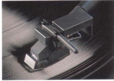
Tonarm mit Moving-Coil-System mc 2-E.
