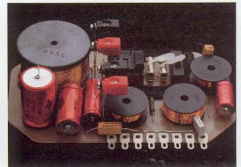
Die hochwertige Frequenzweiche bildet mit der Anschlußplatte eine Einheit.
