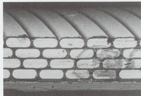
Braun Formband-Spule: 30% mehr Kraft durch 30% höhere Wicklungsdichte.
