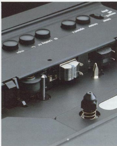
Langes Leben und hohe Bandbreite: Lamellierter Sendust-Tonkopf.
