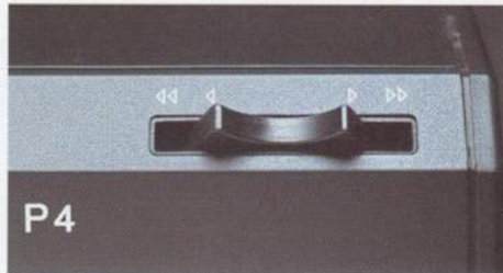
Schaltwippe zur Tonarmsteuerung.
