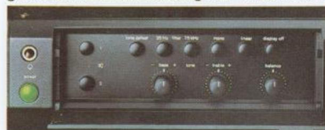
Die weniger oft benutzten Regler und Schalter liegen hinter der Klappe.
