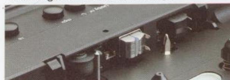
Getrennte Tonkopf-Systeme in "M&X"-Ausführung.
