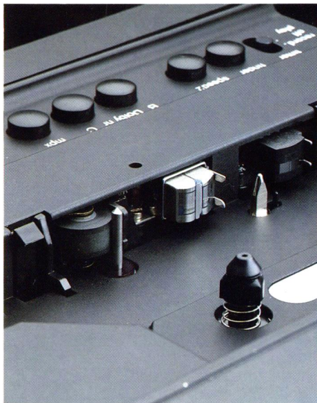
Langes Leben und hohe Bandbreite: Lamellierter Sendust-Tonkopf.
