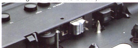
Getrennte Tonkopf-Systeme in „M&X“-Ausführung.
