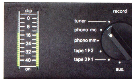
Die "clipping"-Anzeige wird über eine Schaltung gesteuert, die ständig Ein- und Ausgangssignal vergleicht.
