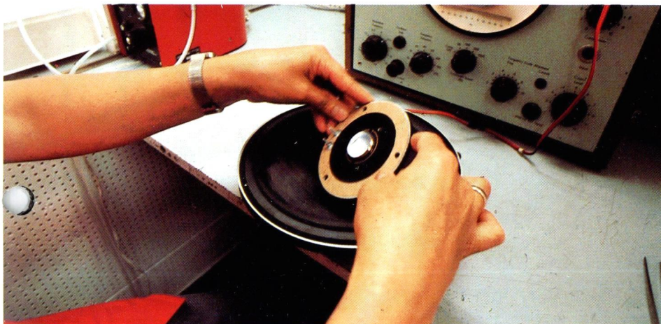
Die Innenbeschichtung der Kalotten erfordert volle Konzentration und ein gutes Auge.
