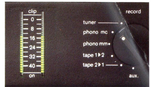
Die "clipping"-Anzeige wird über eine Schaltung gesteuert, die ständig Ein- und Ausgangssignal vergleicht.
