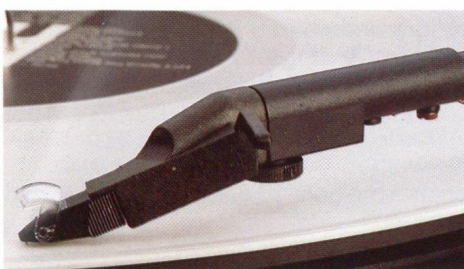
„Ultra Low Mass“-Tonarm mit System MAG 2E.
