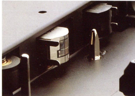
Langes Leben und hohe Bandbreite: Lamellierter Sendust-Tonkopf.
