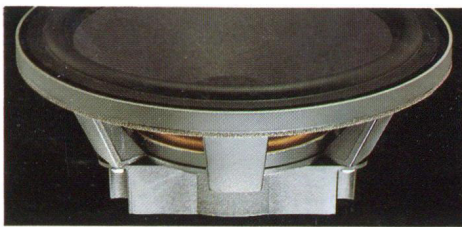
Braun Tieftöner mit "Stiffite" Membran und verwindungssteifem Druckguß-Chassis mit guter Wärmeableitung für hohe Belastbarkeit.
