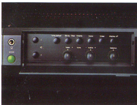
Die weniger oft benutzten Regler und Schalter liegen hinter der Klappe.
