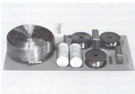
Frequenzweiche einer Dreiweg-Box (L 620/1).
