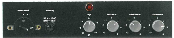
Durch getrennte PegelEinstellung der drei Kanäle kann der Frequenzgang der LV 1020 der Raumakustik angepaßt werden.
