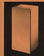
LV 1020 Dreiwegbox mit eingebauten Endverstärkern, für Vorverstärker von 0,39 bis 2,45 V Ausgangsspannung. Zur freien Aufstellung. Nettovolumen 50 l. Baß bis 20 Hz. Maximaler Schalldruck 108 dB in 1 m Entfernung. Verstärkerleistungen 40/20/15 W. Klirrfaktor 0,1%. Abmessungen (B, H, T): 38×74×30 cm. Gewicht 28 kg. Gehäuse weiß oder nußbaum. Vorrichtung zur Befestigung von Fußgestellen.
