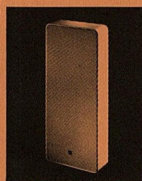
L 550/1 Zweiwegbox, für Verstärker von 10 bis 35 W, zur Wandaufhängung oder Regalaufstellung. Nettovolumen 13 l. Baß bis 30 Hz. Abmessungen (B, H, T): 28×65×12,5 cm. Gewicht 9,0 kg. Gehäuse weiß oder nußbaum. Vorrichtungen zum Hängen.
