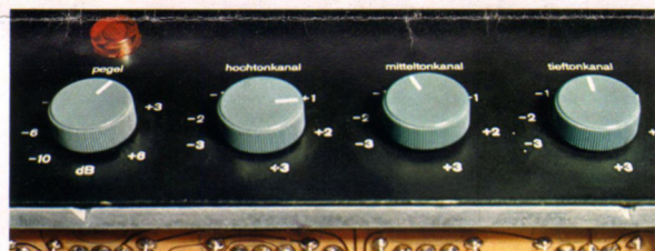
Eine Klangregel-Möglichkeit besonderer Art bieten die neuen Braun Lautsprechereinheiten LV 1020 mit eingebauten Endstufen (Leistungsverstärkern). Jeder der drei Tonbereiche: Hoch, Mittel und Tief, kann für sich in seinem Pegel um 3 dB angehoben oder abgesenkt werden. Damit läßt sich also die genaue Anpassung des Frequenzganges an die Raumakustik bewerkstelligen. Die Klangregler des (Vor-)Verstärkers bleiben frei für die individuelle, programmabhängige Klangregie.
