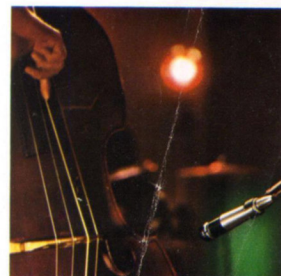
Schlagbaß: Der Abstand des Mikrofons beträgt ca. 20 cm vom Steg der Baßdecke.
