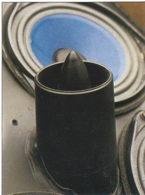
Strömungsgünstig: Der zentrale Kern der Baßreflexöffnung soll Geräusche durch Turbulenzen verhindern.
