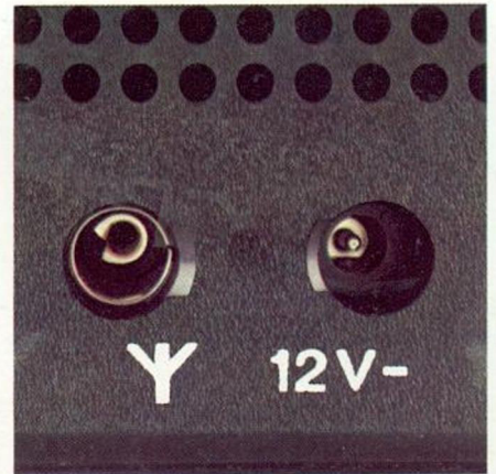
Anschlußbuchse für Außen- oder Autoantenne. Schaltbuchse für externe 12-Volt-Batterie, dazu Anschlußkabel mit Auto-Entstörung.
