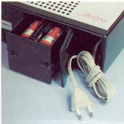
Batterie-Fahrstuhl für blitzschnellen Monozellen-Austausch. Extra-Fach für Eurostecker-Netzkabel.
