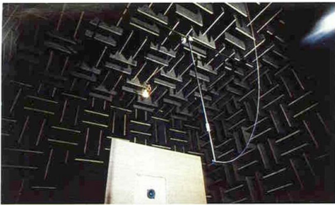
Messen. Grundforderung an einen guten Autolautsprecher: hoher Schalldruck schon beim Ansteuern mit geringer Leistung. Kontrollen im reflexionsfreien Raum bringen genaue Erkenntnisse für den gesamten Übertragungsbereich.
