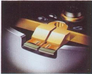
Amorphe Videoköpfe. Gestochene Schärfe, feine Abstufungen, leuchtende Farben – sichtbar vor allem bei intensivem Rot.
