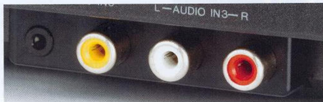
Die Audio-Video-Eingänge liegen zugriffsgerecht auf der Gerätefront.
