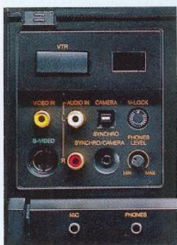
Fronteingänge. Leichter Anschluß von weiteren Videokomponenten für die anspruchsvolle Nachbearbeitung.
