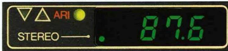
Das Display des Bremen SQR 34: Leuchtdioden für die Anzeige der Senderfrequenz, für ARI und Stereo.
