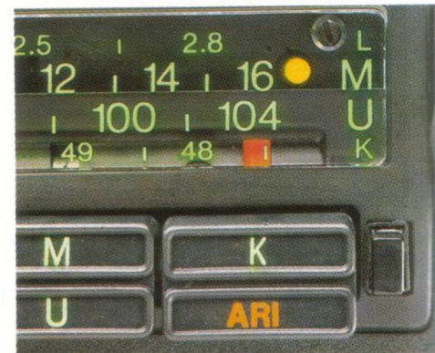
ARI-Taste und ARI-Lampe zur Abstimmung auf Verkehrsfunksender.
