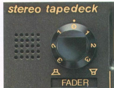
Zusätzlich zum Balance-Regler hat der ACR 931 noch einen eingebauten Überblendregler (Fader).
