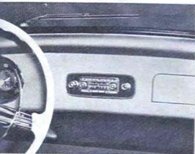
CAPRI in der im Armaturenbrett fest eingebauten Kassette: Betriebsstrom aus der Wagenbatterie, Wiedergabe durch Lautsprecher im Armaturenbrett, Empfang mit Autoantenne.
