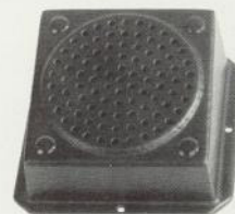
Gehäuselautsprecher 200 Z 1825 Abmessungen: 132 x 132 mm (Höhe 70 mm) Belastbarkeit: 7 Watt
