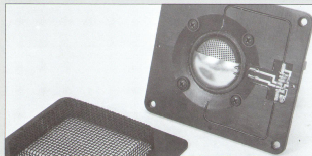
Eine aufgeschnittene Metall-Kalotte mit Gegenelektrode.
