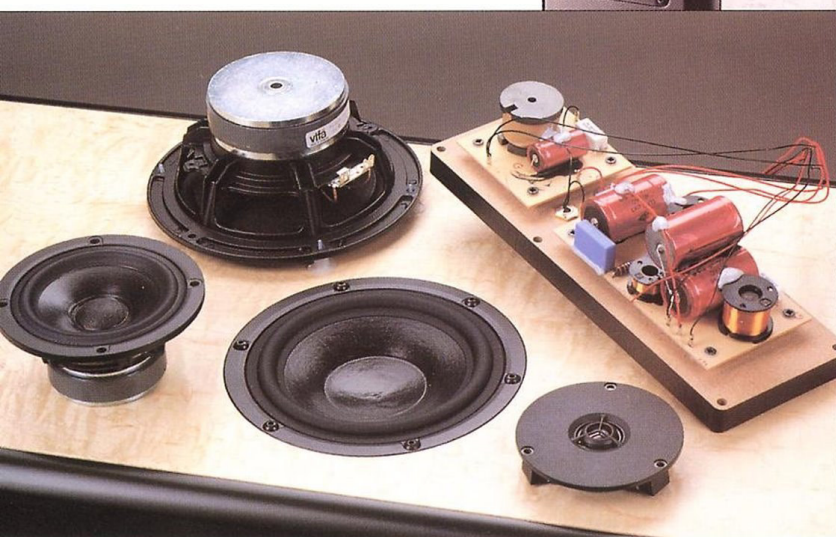
Die hochwertige Bestückung mit getrennter Frequenzweiche für Bass und Mittel- Hochton
