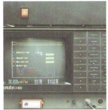
Arcus-Endkontrolle: Messung im schalltoten Raum, Computer-Überwachung.
