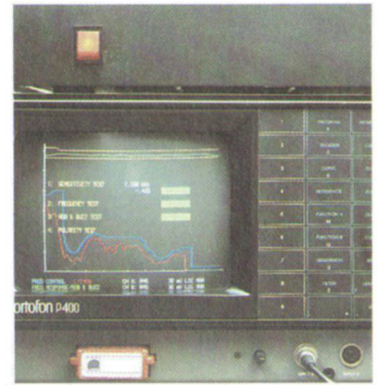
Arcus-Endkontrolle: Messung im schalltoten Raum, Computer-Überwachung.
