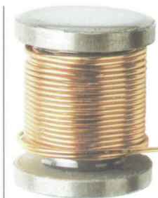
LR (= Low-Resistance)-Spule: ein neuartiger Metallpulverkern.
