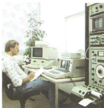
Arcus-Meßlabor: Impulsauswertung am Fourier-Analysator.
