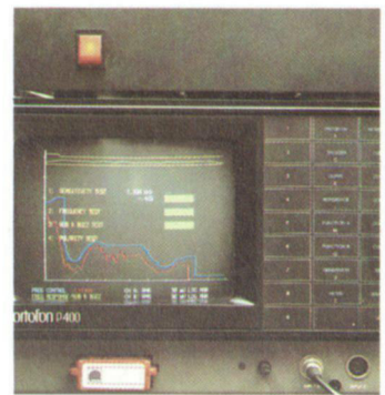
Arcus-Endkontrolle: Messung im schalltoten Raum, Computer-Überwachung.
