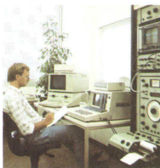
Arcus-Meßlabor: Impulsauswertung am Fourier-Analysator.
