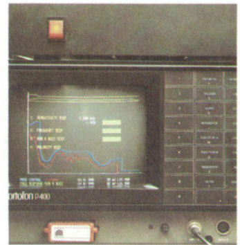
Arcus-Endkontrolle: Messung im schalltoten Raum, Computer-Überwachung.
