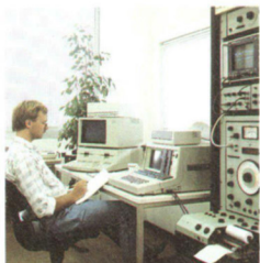
Arcus-Meßlabor: Impulsauswertung am Fourier-Analysator.
