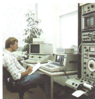
Arcus-Meßlabor: Impulsauswertung am Fourier-Analysator
