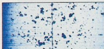
800fache Vergrößerung eines normalen Ferrit-Kopfes nach gleicher Betriebsdauer.
