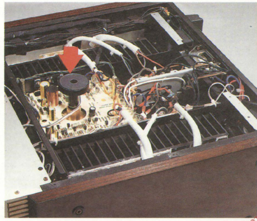
Der Fuß in der Mitte ist das separate Standbein für den Trafoblock. Damit steht die gewichtige Einheit der Ringkern-Trafos mechanisch isoliert vom Gesamtverstärker. Unter dem Gußträger sind weitere Trafos, die die digitalen und analogen Schaltungen vor der Endstufe versorgen.
