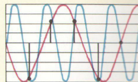
Die tiefe Frequenz (rot) ist das Originalsignal, die hohe Frequenz (blau) ist ein Aliasing-Signal, das aus den gleichen Abtastwerten gebildet wird.
