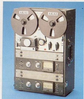
1962, M 7 mit Cross-Field-Technik
