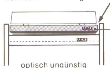
Rack und Zarge nicht aufeinander abgestimmt
