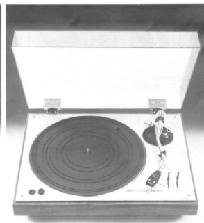
AKAI AP-003 Halbautomatischer HiFi-Plattenspieler* Präzisions- Riemenantrieb, Gleichlaufschwankungen < 0,05%, Rumpelfremdspannungsabstand > 52 dB, statisch balancierter Leichttonarm, Spurführwinkel 1° 30', regelbare Skating-Komponenten, Lateral-Balance, Tonarm-Lift, Norm-Systembefestigung, CD-4-tüchtig *serienmäßig mit Magnetsystem von AUDIO- TECHNICA
