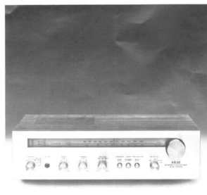
AKAI AA-1010 quarzstabilisierter HiFi-Stereo-Receiver 2 x 16 Watt Sinus, FM-Empfindlichkeit 2 µV, Selektivität > 70 dB, Leistungsbandbreite 20 - 60000 Hz, Klirrfaktor < 0,4%, 1 Phono-, 1 AUX-, 1 Tape-Anschluß, 2 Stereo-Laut- sprechergruppen, 24 Halbleiter, 1 FET, 4 integrierte Schaltungen.
