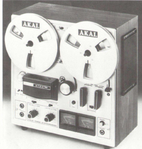
AKAI 1722 W mit Endverstärker und integrierten Lautsprechern 3 Tonkopfsysteme, Frequenzbereich 50-20000 Hz, 1-Motoren-Laufwerk, Gleichlaufschwankungen < 0,2%, Dynamik > 47 dB, Klirrfaktor < 1,8%, eingebauter Endverstärker mit 2 x 10 Watt Sinus Leistung, 2 eingebaute Lautsprecher, Bandsortensummschaltung für Low-Noise- und Wide-Range-Bänder, automatische Endabschaltung
