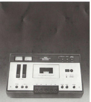
AKAI GX-210 D 3 Tonkopfsysteme in GX-Ausführung*, Frequenzbereich 20-22000 Hz, 3-Motoren-Laufwerk, Gleichlaufschwankungen < 0,09%, Dynamik > 56 dB, Klirrfaktor < 0,9%, Vor- und Hinterbandkontrolle, Bandsortensummschaltung für Low-Noise- und Wide-Range-Bänder *Lebenslange Garantie auf GX-Kristall-Tonköpfe
