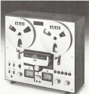
AKAI GX-265 D 4 Tonkopfsysteme, GX-Ausführung*, Frequenzbereich 30-25000 Hz, Auto-Reverse für Aufnahme und Wiedergabe, servogesteuertes 3-Motoren-Laufwerk, Relaissteuerung fernbedienbar, Gleichlaufschwankungen < 0,05%, Dynamik > 60 dB, Klirrfaktor < 0,8%, Vor- und Hinterbandkontrolle, MicLine-Mixing, Duploxy, Bandsortensummschaltung für Low-Noise- und Wide-Range-Bänder *Lebenslange Garantie auf GX-Kristall-Tonköpfe
