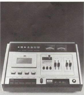
AKAI GX-75 D Top Loading 4 Tonkopfsysteme, GX-Ausführung*, Frequenzbereich 40-15000 Hz (Co), Auto-Reverse für Aufnahme und Wiedergabe, 1 Synchronmotor, Gleichlaufschwankungen < 0,19%, Dynamik > 52 dB > 60 dB mit Dolby, Klirrfaktor < 1,0%, Limiter, 2fach-Bandsortensummschaltung, Zählerwerk mit Memory, Flachbahnräger *Lebenslange Garantie auf GX-Kristall-Tonköpfe
