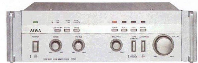
SA-C30 HiFi-Stereo-Vorverstärker Differential-Verstärker mit Dual-Positiv-/Negativ- Netzteil. Phono-Entzerrung nach RIAA. Eingänge: Phono, Tuner, Tape, Aux. Loudness-Schalter. Low-Filter. Muting -20 dB. Monitor-Möglichkeit.
