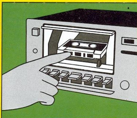
Durch ein Hydrauliksystem wird die Cassette lautlos und automatisch in Abspielposition gebracht und eingerastet.
