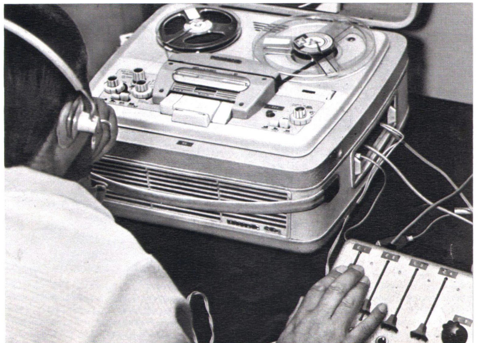
Erfahrung, technische Hilfsmittel und kleine Tricks lassen die klangreinen Aufnahmen ohne störende Nebengeräusche gelingen. Die Minuten- und Stundenschläge, Orgelmelodien und Glöckenspiele werden genau dosiert über ein Mischpult aufgenommen.
