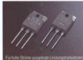
Für hohe Ströme ausgelegte Leistungstransistoren
