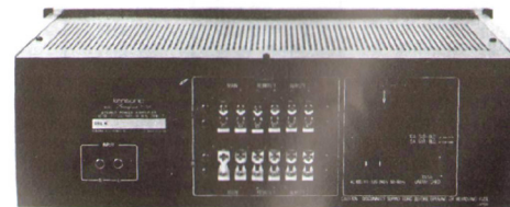
Fig. 13. — Vue du panneau arrière de l'amplificateur ACCUPHASE P 300.
