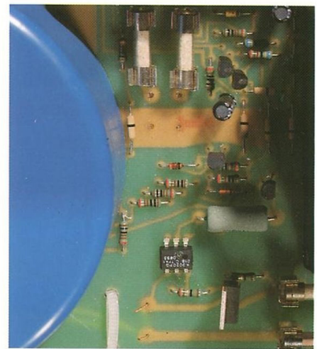
Ein Optotriac schaltet die Netzspannung
