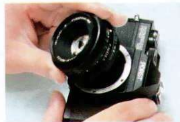
Schneller Objektivwechsel mit PK-Bajonettanschluß.
