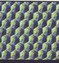
Mikrowaben-Einstellscheibe (200fach vergrößert)
