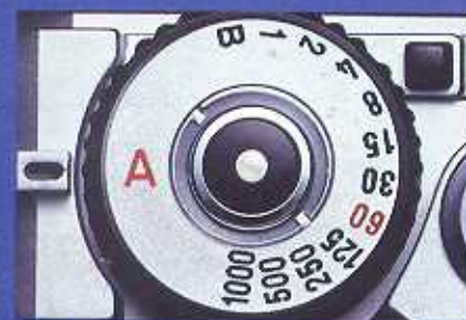
Steht das Verschlusszeiten- und Funktionsrad der XG-M auf »A«, schaltet die Kamera in Automatik-Funktion mit Zeitsteuerung.
