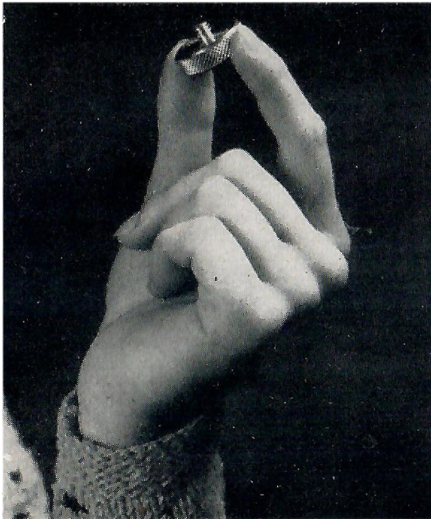
Vorsatzlinse II, Abbildungsmaßstab 1 : 8,9, Tiefenschärfe 6,4 cm. Das Bild zeigt das Übergangsgewinde vom englischen auf Normalgewinde, das für Stativarbeit mit der Retina notwendig ist.
