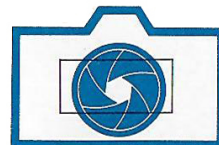
Blende schließt sich auf vorgeählten Wert. Verschuß läuft ab.
