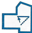
Spiegel in hochgeklappter Stellung.
